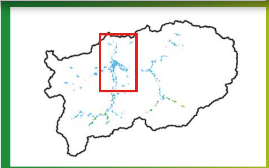
山崎断層による地震が発生した場合の震度によって、地域の建物が全壊する確率を表しています。
